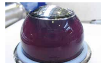
■ Zerlegte Armatur mit Agar / Disassembled valve with agar
