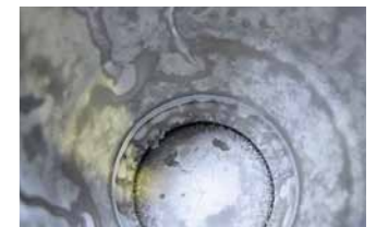
■ Verschmutzung / Contamination / soiled valve body
